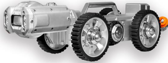
G15B主要用于风电叶片内窥检测，可对叶片内部的鼓包、褶皱、脱胶、裂痕等缺陷进行内窥检测。本款机器人相比G150A设计更加小巧轻便、检测距离长，可以适应叶片内部复杂的状况，为风电叶片的验收、维护等提供可靠的视频与图像依据。
