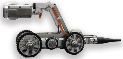
G150A配备强力照明光源和高精度计米线缆卷收装置，可根据车体行进速度自动匹配收放线速度，收线过程自动排线。可对管道内部进行视频录像、缺陷抓拍、记录缺陷位置信息及制作专业的检测报告。
